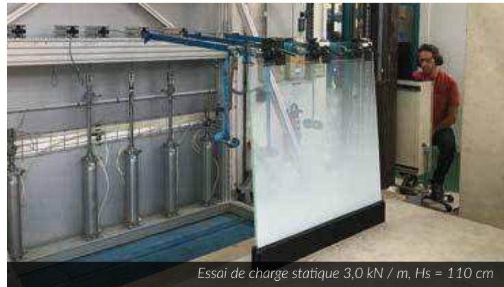
Essai de charge statique SLE, 1,0 kN / m, Hs = 110 cm
